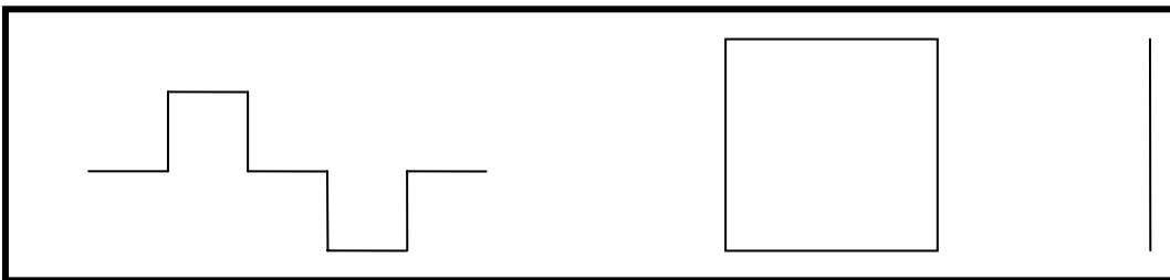
Figura 2. a) pulso eléctrico bipolar b) arreglo sencillo (single loop)
